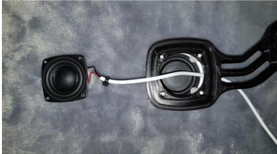
Setzen Sie den Lautsprecherarm auf das Lautsprechergehäuse.
