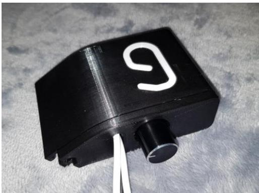
Drücken Sie die Rückplatte (GT\_Air\_Box\_Back) in die vordere Verstärkerbox (GT\_Air\_Box\_Front), bis diese von selbst einrastet.
