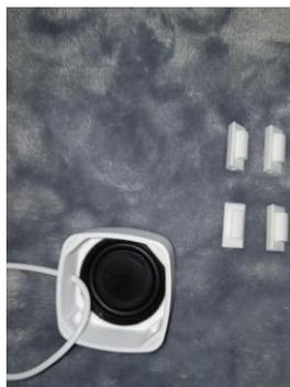
Setzen Sie den Halteringsring (GT\_Air\_Cover\_Reflex) in die zylindrische Aussparung der Lautsprecherabdeckung ein.
