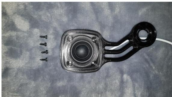
Setzen Sie den Lautsprecherrahmen (GT\_Air\_Speaker) in die Fassung auf dem Lautsprecherarm ein.
