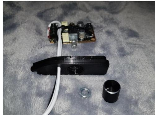
Schließen Sie das rechte 50 cm Audiokabel am linken oberen Sockel des Droking PAM8406 Verstärkers an.
