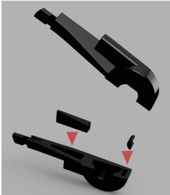
Die Klammern des Strap Adapters wurden wegen der besseren Druckbarkeit aufgeteilt. Die Dateien sind mit dem Suffix „\_FDM“ versehen.
