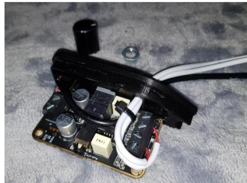
Befestigen Sie die Verstärker indem Sie die Mutter aufschrauben.
