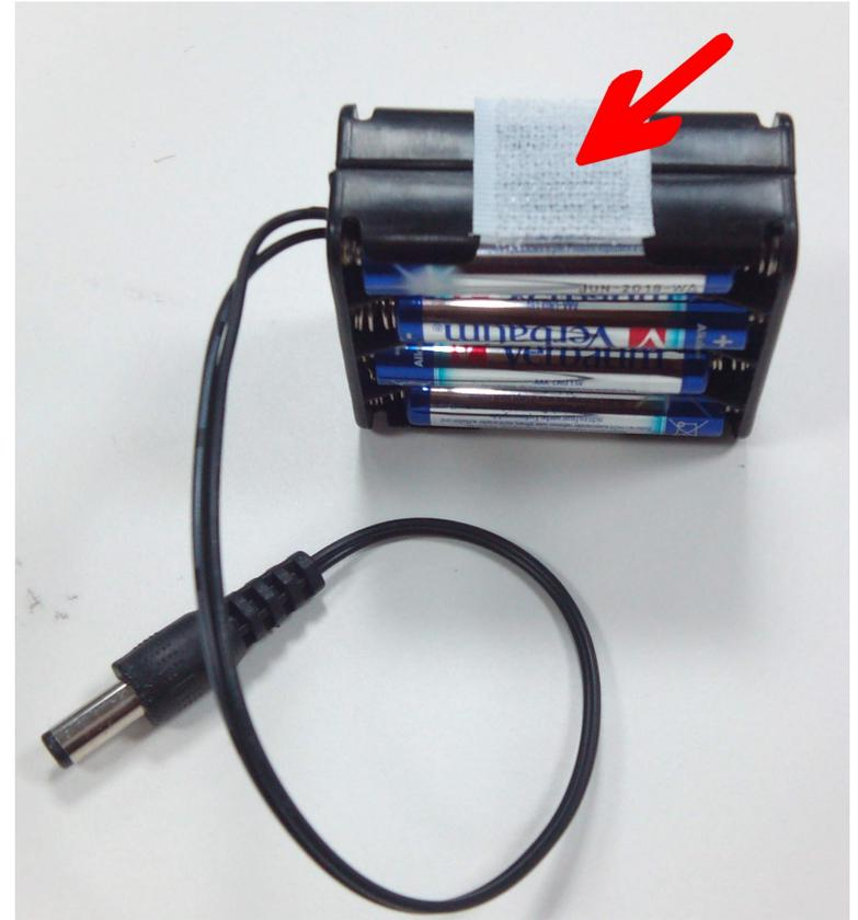
*Pegamos velcro adhesivo en la parte interior de la pieza indicada y en el portapilas.*
