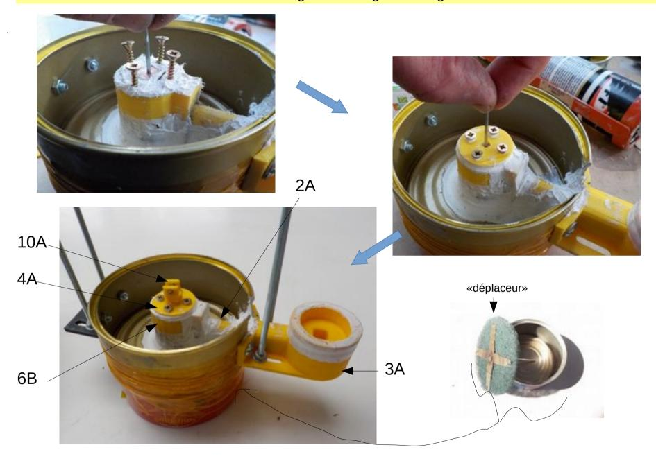
19 – poser la membrane (ballon de baudruche) qui doit être pincée par l'ensemble chape rondelle 11B
