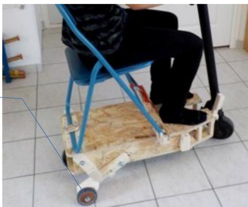
Option conduite avec stabilisation supplémentaire : deux roues en plus (8) pour limiter le risque de basculement.
